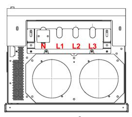
Fig. 37: Connection ECOsine® active FN3430-100/120-400-4
